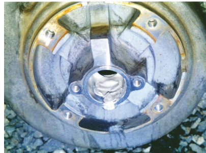
分解状況 スタフィンボックス内部 石灰石付着状況
