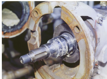
分解状況 メカニカルシール外表面 石灰石付着状況
